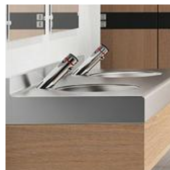
Selbstschluss-Mischbatterie für Waschtisch TEMPOMIX 3 Bis zu 85 % Wasserersparnis dank automatischem Schließmechanismus nach 7 Sekunden Laufzeit und einer Durchflussmenge von 3 l/min Art. DELABIE : 794100
